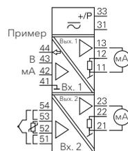
Программируемый преобразователь с концевым выключателем
